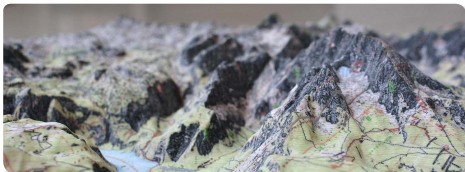
3D-Druck aus den Daten der Topographischen Karte mit Geländedaten
