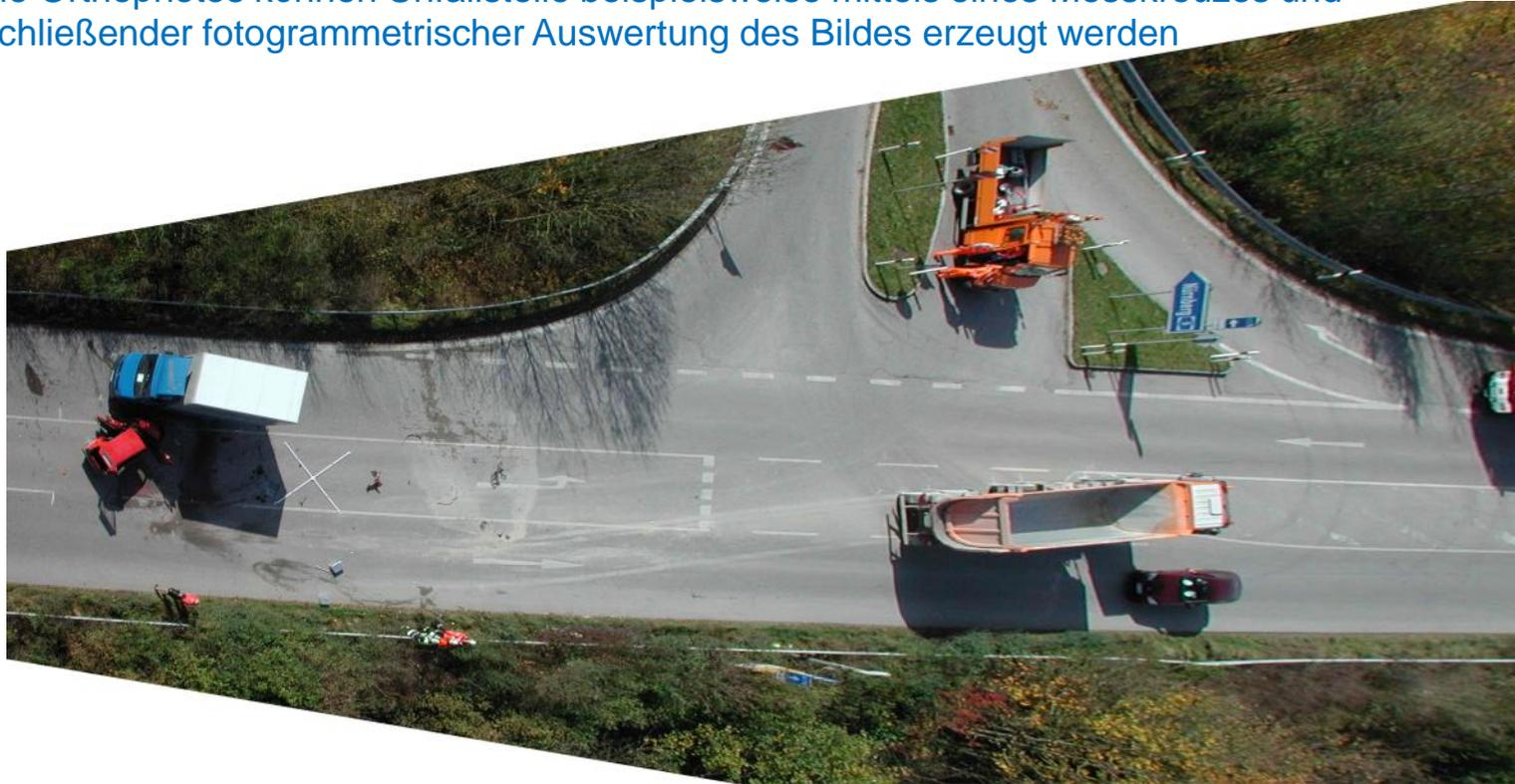
Bei der Verwendung von verzerrungsfreien Luftbildern mit hoher Auflösung entfällt ein großer Teil der Vermessungsarbeit auf der Fahrbahn!
