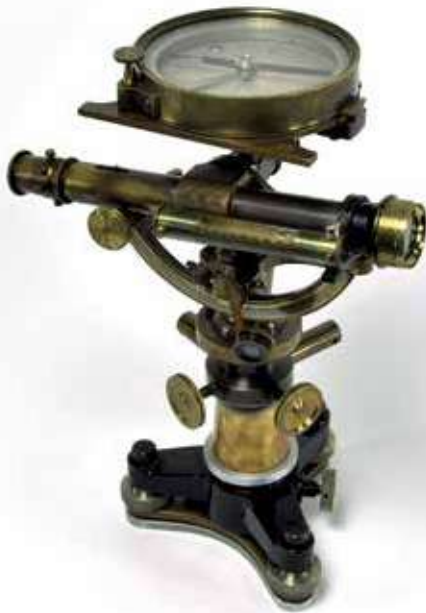
Abb. 059: Bussolentachymeter (Topometer) der Münchner Firma Ertel & Sohn, 1920
