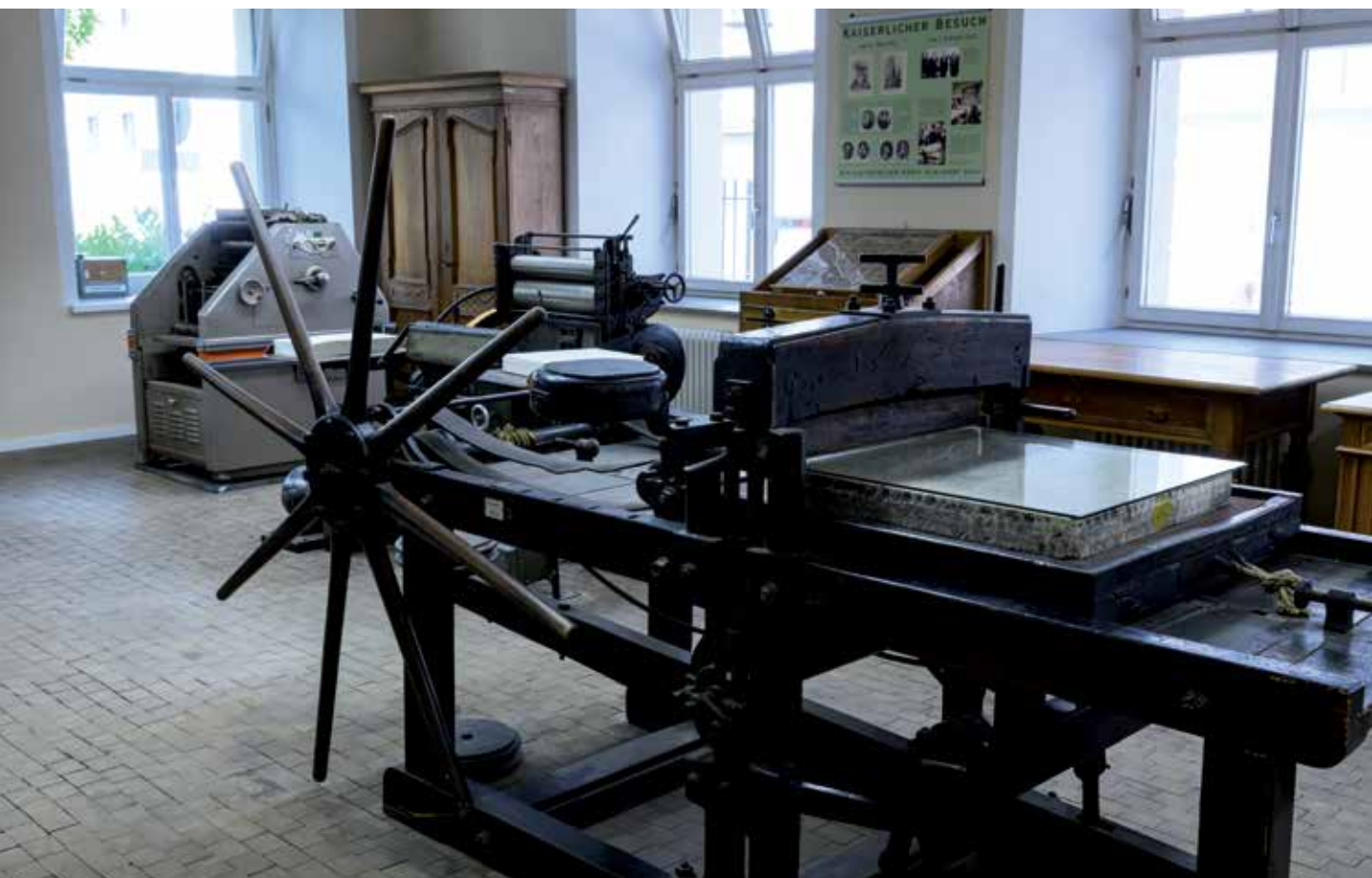
Abb. 127, oben: Handhebelpresse, Fa. Krause, 1934
