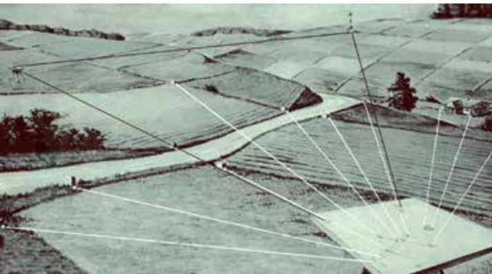
Abb. 95: Schematische Darstellung des Messtischverfahrens
