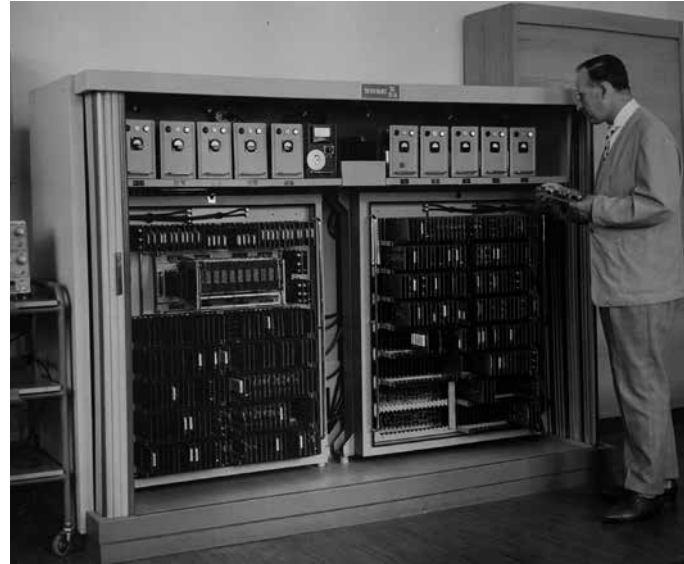
Abb. 028: Am Landesvermessungsamt standen eine Zuse Z23 und eine Z64 (Graphomat) als Kartiergerät zur Verfügung
