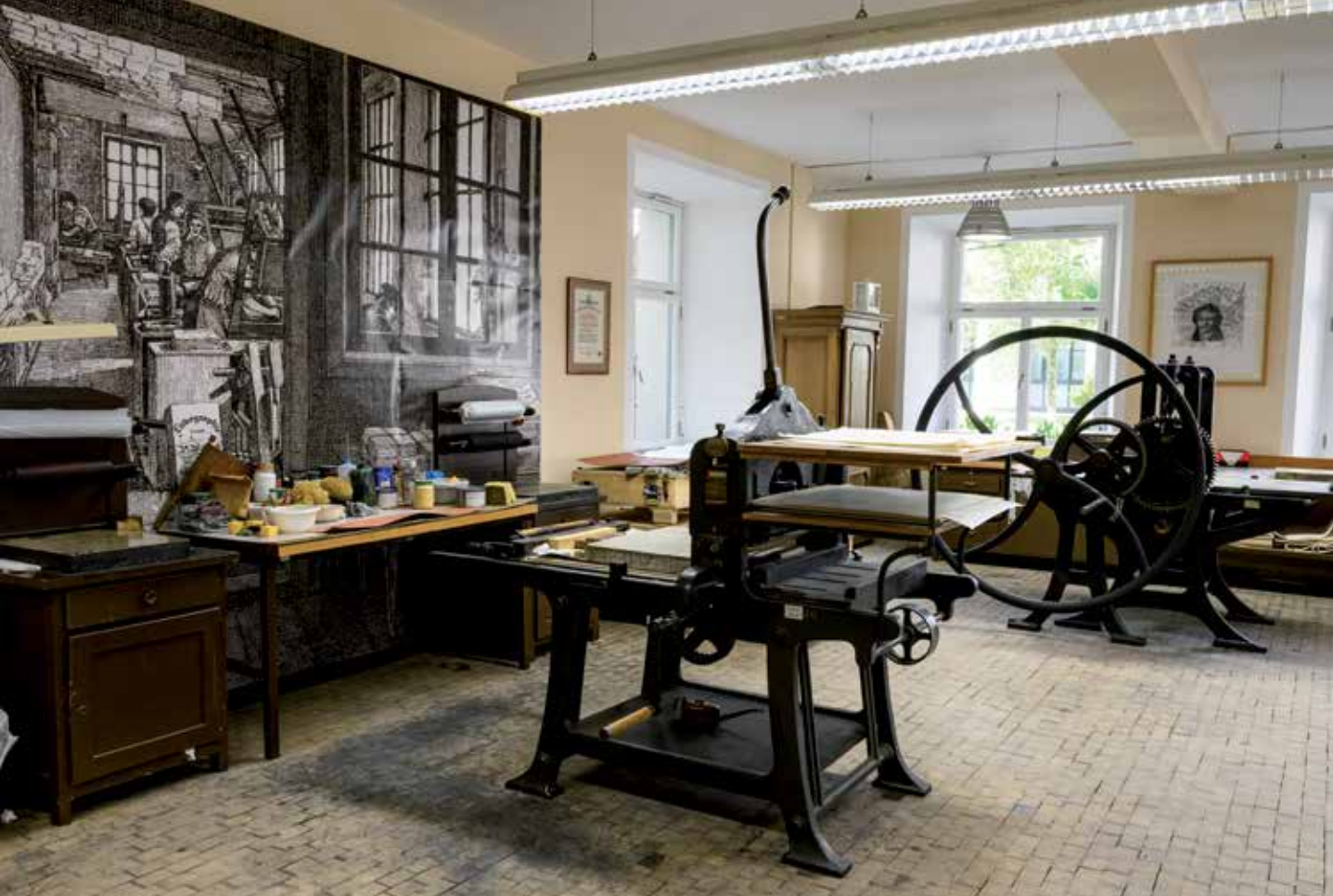
Abb. 127, oben: Handhebelpresse, Fa. Krause, 1934
