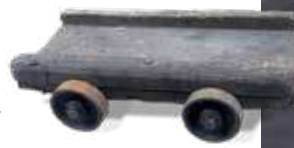
Abb. 115: Historischer Transport-Roller für einzelne Lithographiesteine
